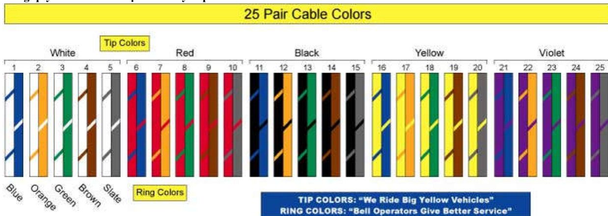
Bảng quy chuẩn màu được trên dây cáp.
