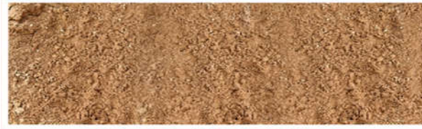
Cát vàng xây tô - Cát đổ bê tông ( cát Tân Ba ) (Toàn bộ công trình đều sử dụng cát này, trừ hạng mục sân lấp)
